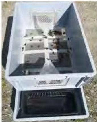
Bac de Capture Préventif Autonome (BCPA) Bac norme Europe XL (grande capacité). 40x60 équipé de MAS polycarbonate
